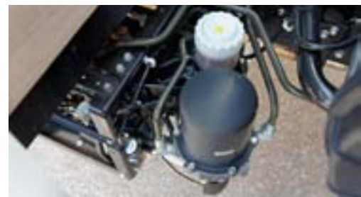
На некоторых моделях бачок для тормозной жидкости выведен наружу рамы автомобиля
