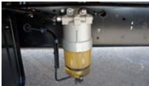
Топливный фильтр-сепаратор обязателен для всех автомобилей
