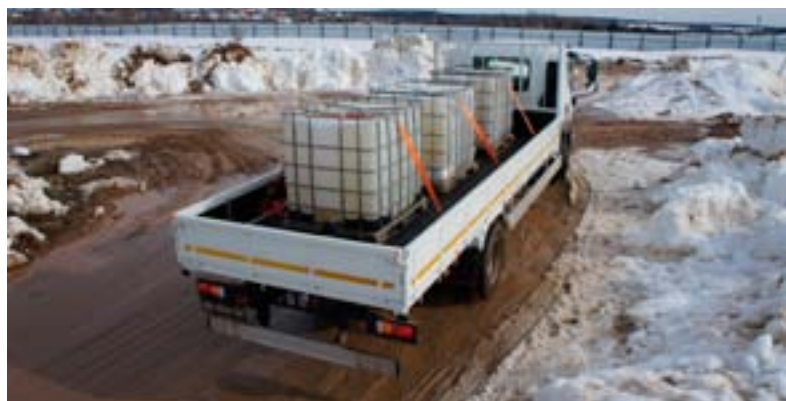
Для балласта автомобили загрузили емкостями с водой
